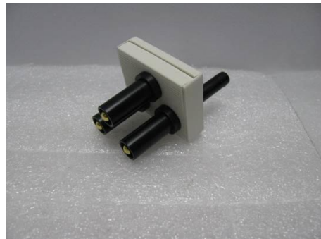
CA M2/M3/AF3(N) EM Test Stil für R-100N CA M2/M3/AF3(N) EM Test style fits for R-100N
