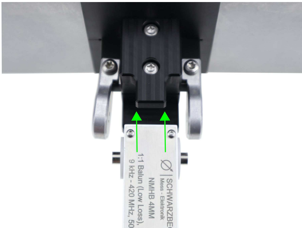
Bild 4: Der NMHB 4MM Balun wird in die Balunaufnahme des FDAI-Elements eingeschoben, wobei die Beschriftung nach oben zeigt
