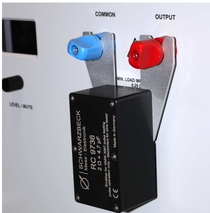
Bild 1: Montage des RC 9736 an den Klemmen des Leistungsverstärkers LFPA 9733 C Fig. 1: Mounting of RC 9736 at the terminals of the power amplifier LFPA 9733 C
